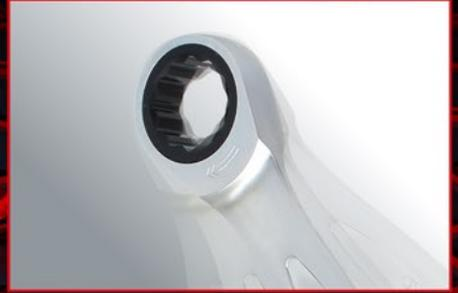
Der besonders robuste Ratschenmechanismus mit 72 Zähnen arbeitet mit einem Rückstellwinkel von nur 5° und ermöglicht damit das Arbeiten auf engstem Raum. Der von einem Standard Ringmaulschlüssel benötigte Rückstellwinkel beträgt hingegen mindestens 30° und erfordert ständiges Nachsetzen des Schlüssels. Dieses umständliche Verfahren gehört nun der Vergangenheit an.
