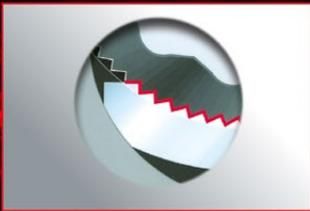
Die weiterentwickelte, progressive Verzahnung erlaubt die Übertragung von bis zu 30% mehr Drehmoment im Vergleich zu bisherigen Ratschenringschlüsseln. Die Komponenten des Ratschenmechanismus sind aus besonders vergütetem Stahl hergestellt. Dadurch erreicht bzw. überbietet der GEARplus® die DIN und ANSI Drehmoment-Normen für Standard Ringmaulschlüssel.
