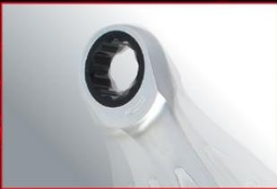
Der besonders robuste Ratschenmechanismus mit 72 Zähnen arbeitet mit einem Rückstellwinkel von nur 5° und ermöglicht damit das Arbeiten auf engstem Raum. Der von einem Standard Ringmaulschlüssel benötigte Rückstellwinkel beträgt hingegen mindestens 30° und erfordert ständiges Nachsetzen des Schlüssels. Dieses umständliche Verfahren gehört nun der Vergangenheit an.
