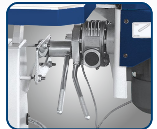
KSO 150 M Schleifaggregat über Hebel bis 45° schwenkbar
