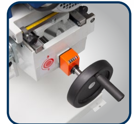
▶ Bohrkopf auf gehärteten Prismenführungen mit Kugelkontaktsystem gelagert ▶ Einfache und präzise Höhenverstellung über Handrad und numerischer Anzeige
