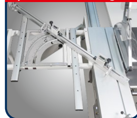
► Besäumrahmen mit CompeX Vorrichtung für Gehrungsschnitte mit automatischem Längenausgleich
