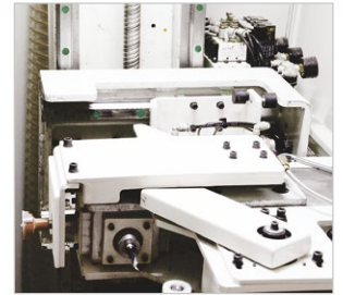
▶ Kreuzkopf Bohrregulat mit vier horizontalen Spindeln
