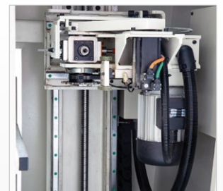
▶ Nutfräse an der Unterseite des Bohrregulats
