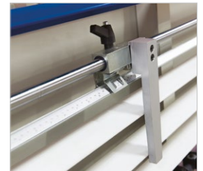
▶ Lineal zur Längeneinstellung beim Vertikalschnitt
