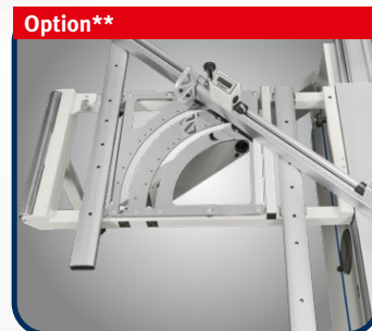
Option** CompeX ▶ Zur schnellen und genauen Ausführung von Gehrungsschnitten mit automatischem Ausgleich der Anschlagposition ▶ Modell si x A3 UP X: bereits in Ausstattung enthalten
