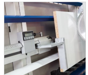
▶ Digitale Maßanzeige zur Längeneinstellung beim Vertikalschnitt
