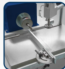
▶ Winkelanschlag +/- 45° mit Skala optional erhältlich
