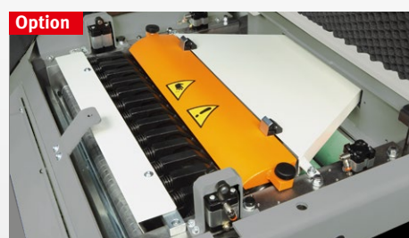
Abb. zeigt Option "Pneumatische Druckeinstellung der Vorschubwalzen" für PS 630
