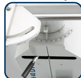
▶ LLB 40 DT: Arbeitstisch beidseitig um 60 Grad drehbar
