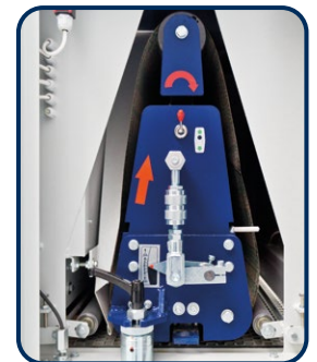
Serienmäßig mit gerippter Stahlwalze Ø 120 mm und hartem Schleifschuh mit Graphitbelag
