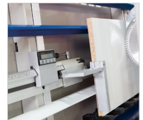
▶ Digitale Maßanzeige zur Längeneinstellung beim Vertikalschnitt
