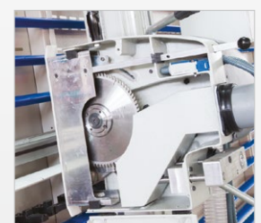
▶ Große Öffnung für Sägeblattwechsel
