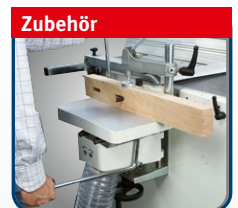
Option Langlochbohrereinrichtung mit Wescott-Bohrfutter 0-16 mm
