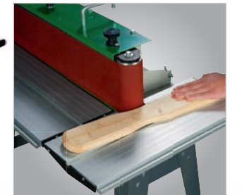
Einfachstes Schleifen von Radien
