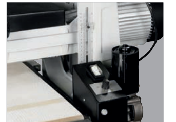
Höhenverstellung der Schleifeinheit an einer Skala ablesbar
