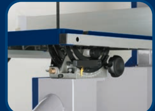
Abb. zeigt HBS 431/433/533 · Sägetisch-Doppel-Wippaufnahme · Die Tischneigung von -10° bis +45° erfolgt über ein präzises und leichtgängiges Zahnsegment mit Knauf
