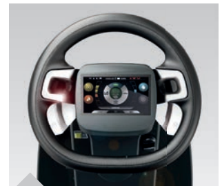
Lenkrad in der Ausführung „PLUS“ mit Touchscreen-Bedienfeld und Schaltwippen für Arbeitsdruck und Rückwärtsgang
