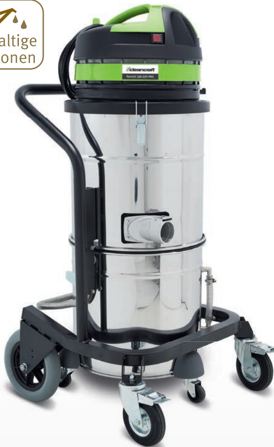
Patentiertes Flow-Mix System: Über Schieber kann höhere Luftmenge bei gleichbleibendem Unterdruck oder höherer Unterdruck bei leicht erhöhter Luftmenge ausgewählt werden
