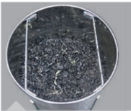
Metallspäne werden durch einen Sieb von der Kühlflüssigkeit getrennt
