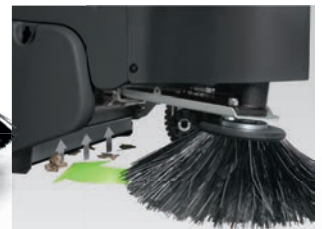
Seitenbürsten mit elektrischer Staubabsaugung
