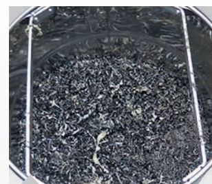
Edelstahlbehälter ist unempfindlich gegenüber scharfkantigen Metallspänen
