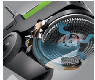
Gründlich und sparsam Reinigungslösung wird von einer Pumpe mit konstantem Durchfluss abgegeben. Die Verteilung beginnt in der Mitte der Bürste, und sorgt damit für gleichmäßige Sauberkeit auch bei geringem Wasserverbrauch
